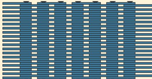
Dichte Legart "L": Bestehend aus Lasche an Lasche hat diese Zahnkette eine relativ geschlossene Oberfläche. Bei kleinen Auflageflächen, wie kleinen Flaschen usw., ist diese Legart von Vorteil. Diese Zahnkette besitzt die grösste thermische Masse und weist am wenigsten Zwischenraum auf, unterliegt damit auch am wenigsten thermischen Schwankungen.
