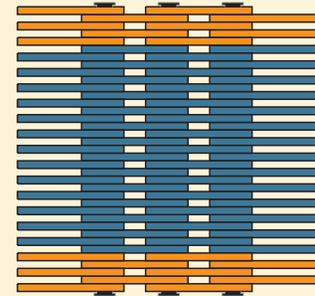
**Mehrfachseitenführung "M"** Die Führungslaschen werden als verstärkte Aussenführung seitlich der Zahnkette angeordnet. Eine erhöhte Belastbarkeit bei langen Transportstrecken und eine verbesserte Verschleissfestigkeit durch die mehrfachen Auflageflächen sind die Vorteile dieser Führungsart.
