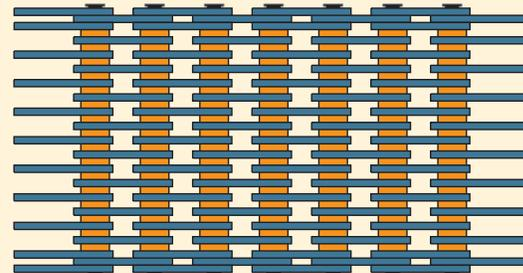
Aufgelockerte Legart "S": Zwischenscheiben werden bei dieser Legart zwischen die Laschen gelegt. Damit wird die Zahnkette leichter, Kühlluft kann besser zirkulieren und Schmutzpartikel fallen leichter durch die grösseren Zwischenräume. Die Auflagefläche ist kleiner.
